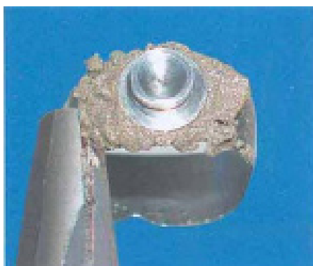
Fig. 6 – La pasta d'argento necessaria per la saldobrasatura di un perno della cerniera di Herbst® precedentemente puntato alla banda
