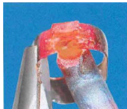
Fig. 13 – Il procedimento di saldobrasatura con una puntatrice
