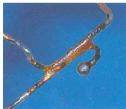
Fig. 11 – La saldatura surriscaldata uniformemente fino a sua completa liquefazione
