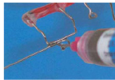
Fig. 4 – Applicazione della saldatura sulle parti
