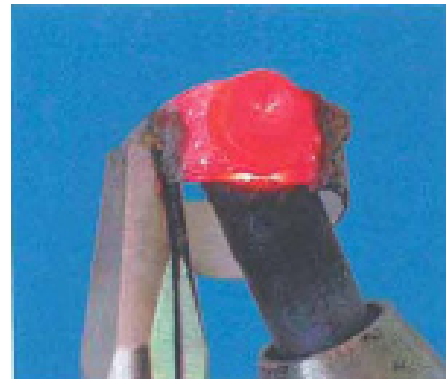
Fig. 12 – La saldatura in pasta per la saldobrasatura di un perno della cerniera di Herbst® liquefatta con una puntatrice
