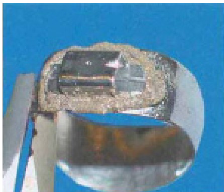
Fig. 7 – Attacco puntato su banda e circondato da saldatura in pasta
